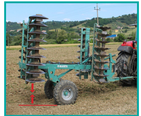
Visoka prohodnost u transportu. Extremely underbeam clearance transport Elevé hauteur sous age pour le transport Luz-libre elevada para el transporte.
