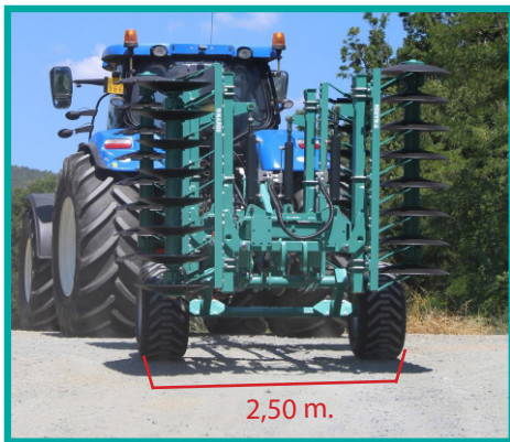
Transportna širina 2,50 m. Road overall dimension 2.50 m. Encombrement routier 2.50 m. Gàlibo del vehiculo 2.50 m.
